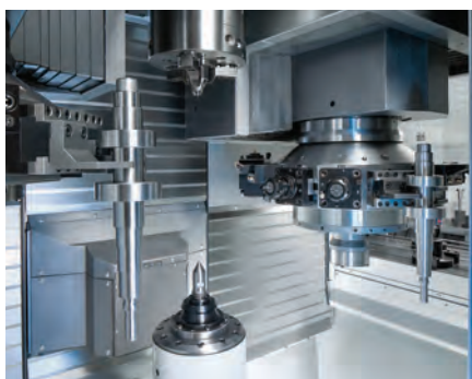
Pomocí chapačů v obou revolverových hlavách se stroj nakládá, resp. vykládá. Přísun obrobků se provádí pomocí postranních automatizačních pásů.
